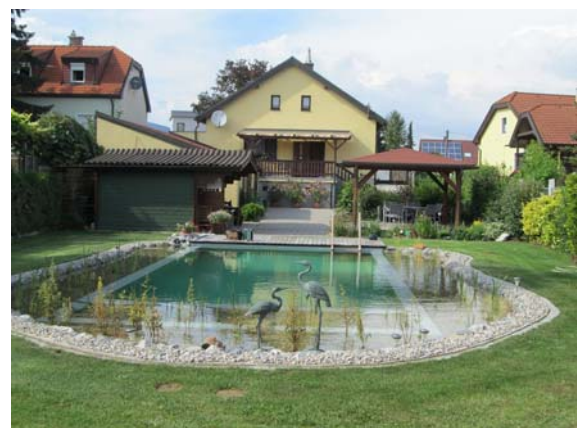
Abb.2 Im Bildvordergrund liegt der Kiesfilter, links und rechts im Bild bepflanzte Uferzonen (keine Filterzonen)
